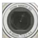
[01] OBJEKTIV Kamerans 8,3x zoomobjektiv har ett zoomomfång på motsvarande 36-300 mm. Zoomen är förhållandevis snabb.
